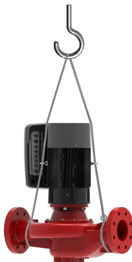
Opción de elevación 2: eslinga alrededor de las bridas de la bomba y uso de los ojales del motor como guías para mantener el equilibrio durante la elevación.
