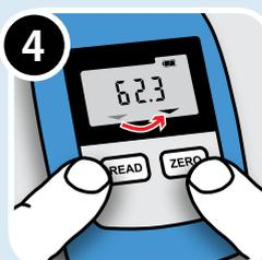
ZEROボタンを押しながらREADボタンを押すと測定項目が切り替わる(DUOモデルのみ)
