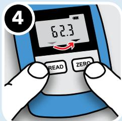
ZEROボタンを押しながらREADボタンを押すと測定項目が切り替わる(ダブルスケールモデルのみ)
