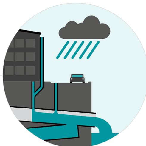
**Desbordamiento del sistema de alcantarillado combinado**
