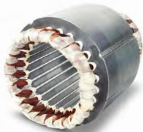
**ORIGINAL FLYGT STATOREN** sorgen für eine optimale Motorleistung und eine erhöhte Wirtschaftlichkeit. Die Toleranz von hohen Betriebstemperaturen verlängert die Lebensdauer des Motors. Eine überragende Kupferdrahtisolierung, erreicht durch eine hocheffiziente und umweltfreundliche Imprägnierung, minimiert das Risiko von Kurzschlüssen und sorgt für einen zuverlässigen Betrieb an Frequenzumformern (VFD).
