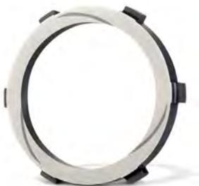
**DIE ACTIVE SEAL-Technologie** von Flygt verbessert die Zuverlässigkeit der Abdichtung, indem die innere Dichtung des Doppeldichtungssystems als Mikropumpe agiert. Lasergeschnittene spiralförmige Nuten in der Dichtfläche der inneren Dichtung pumpen Flüssigkeit vom inneren zum äußeren Durchmesser des Dichtrings und verhindern so, dass Flüssigkeit in das Statorgehäuse eindringt.
