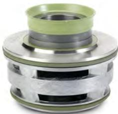
**FLYGT PLUG-IN SEALS™** verfügen über zwei unabhängige Gleitringdichtungen (innen und außen) in einer einzigen, einbaufertigen Einheit. Für die Installation sind keine besonderen Werkzeuge erforderlich und das intelligente Design schützt empfindliche Dichtflächen und Federn vor Verunreinigungen. Ausgewählte Varianten verfügen über unsere patentierte, Leckage verhindernde Active Seal-Technologie.
