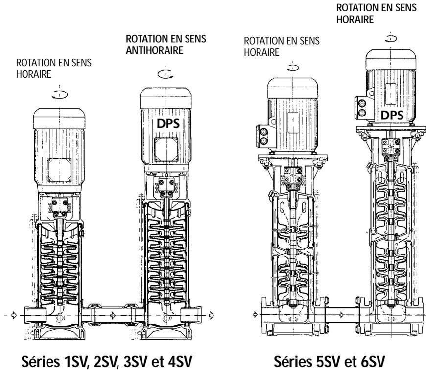
Afin d'installer la pompe correctement, voir les illustrations ci-dessus montrant les sens de rotation et d'écoulement. Les pompes DPS porteront une étiquette indiquant précisément le sens de rotation et le sens d'écoulement. Ne pas tenir compte des flèches coulées à même le corps de pompe. La DPS est la seconde pompe illustrée, après la SSV.
