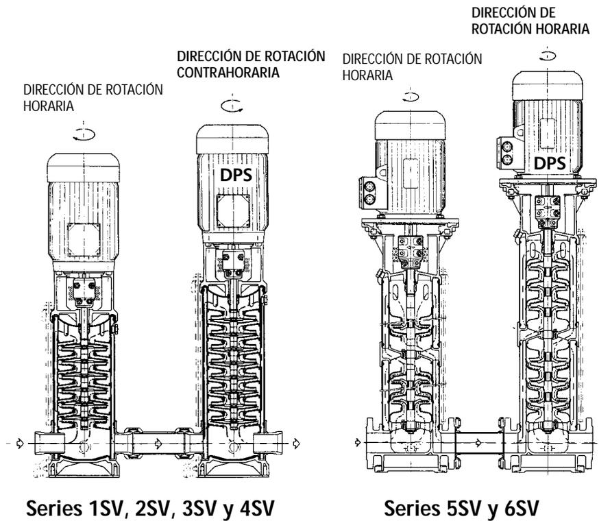
Consulte el diagrama anterior para la instalación adecuada de la bomba detallando la dirección de flujo y la rotación del motor. Todas las unidades DPS se marcarán correctamente con las etiquetas de dirección de flujo y rotación del motor. Ignore todas las flechas de dirección en la pieza fundida. Note que la bomba DPS es la segunda unidad después de la unidad SSV principal.
