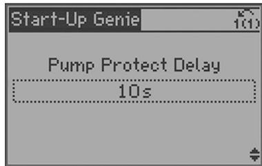
L'alarme de protection de pompe sera réinitialisée conformément au *Mode de réinitialisation [14-20]* et à la *Durée de redémarrage automatique [14-21]*.
