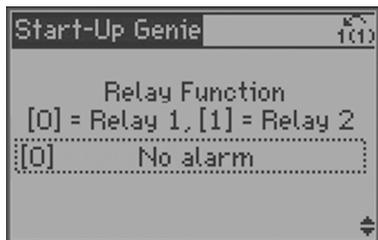
L'écran de la fonction du relais est un écran de paramètre de tableau. Vous reporter à la section programmation de la commande pour les détails sur la programmation d'un écran de paramètre de tableau.
