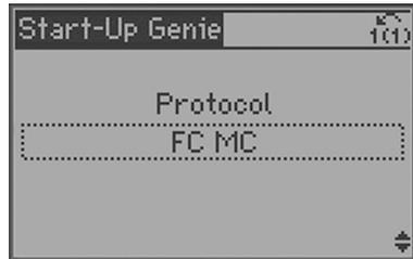
Un jeu de paramètres légèrement différents doit être configuré pour configurer chaque protocole. Utiliser le Génie pour guider la configuration de chaque protocole.
