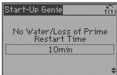
La *Temporisation de la protection sans eau/perte d'amorce* [22-27] est la durée entre la détection de la condition sans eau/perte d'amorce et l'action de l'alarme sans eau/perte d'amorce. La durée de la *Temporisation de Protection sans eau/perte d'amorce* [22-27] peut être prolongée pour éviter le déclenchement de nuisance. Noter que le prolongement de la durée permettra à la pompe de fonctionner à sec ou sans amorce pour la durée indiquée.
