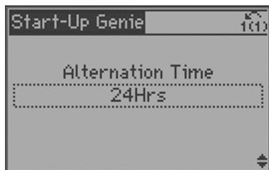
**Remarque :** la pompe de tête peut être alternée manuellement en appuyant sur [OK] et les touches de flèche droite sur l'entraînement de tête.
