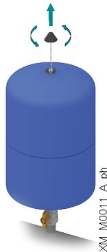
3. Appliquer le manomètre sur la vanne et vérifier la pression.
