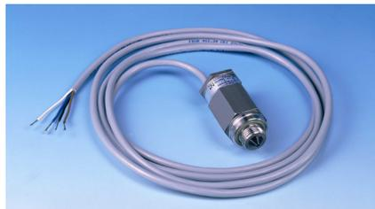
Sensore di rilevamento della presenza dell'acqua basato sul principio opto-elettronico, quindi non invasivo e senza parti in movimento. Il sensore fornisce un contatto elettronico (on/off) da utilizzare per fermare l'elettropompa in caso di mancanza acqua nella zona della tenuta meccanica.
