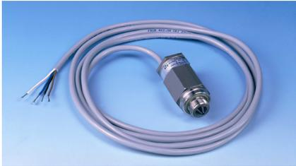
El sensor para la detección de presencia de agua se basa en un principio optoelectrónico, por lo tanto no es invasivo y no dispone de piezas en movimiento. El sensor dispone de un contacto electrónico (encendido/apagado) que detiene la bomba si no hay agua en el área de sellado.
