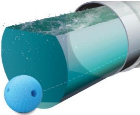
La SmartBall® est une petite balle qui permet d'identifier les fuites de façon très précise sur de longues distances en circulant dans les canalisations sous pression. Il s'agit d'un outil autonome destiné à examiner les canalisations d'eau et d'eaux usées sous pression, à partir du DN 300 mm.
