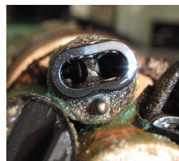
従来のCT電極 構造的にセンサ内部までクリーニングブラシが届かない
