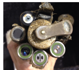
センサクリーニングが可能な電極構造に改良!!
