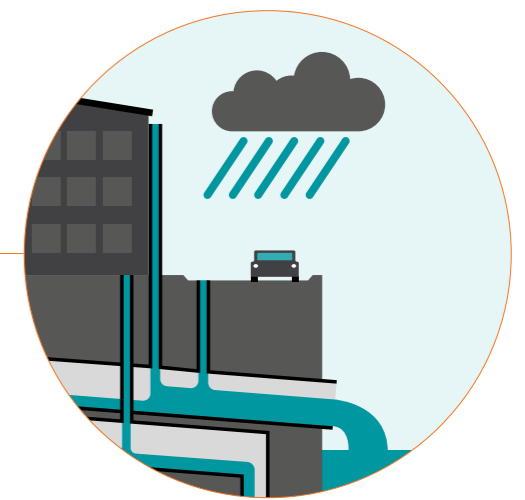
Separate Sewer Overflow (SSO)
