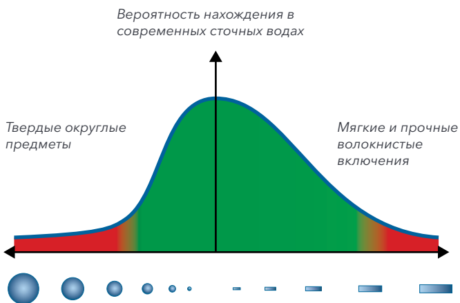
Рисунок 11: Возможности моделей с современным самоочищающимся дизайном гидравлической части
