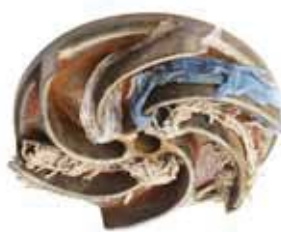
Рисунок 6: Налипание загрязнений на вихревом рабочем колесе
