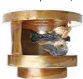
Рисунок 4: Налипание загрязнений на канальном рабочем колесе
