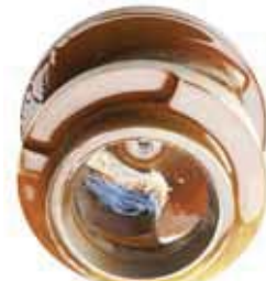
Рисунок 5: Налипание загрязнений на канальном рабочем колесе
