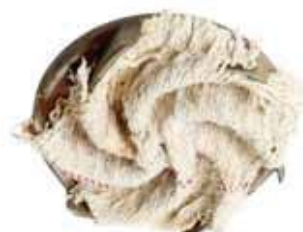
Рисунок 7: Налипание загрязнений на вихревом рабочем колесе
