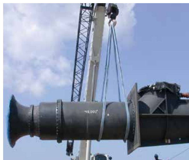
Série AC, grande pompe à colonne verticale
