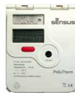
Intégrateur de mesure de consommation d'énergie PolluTherm ®
