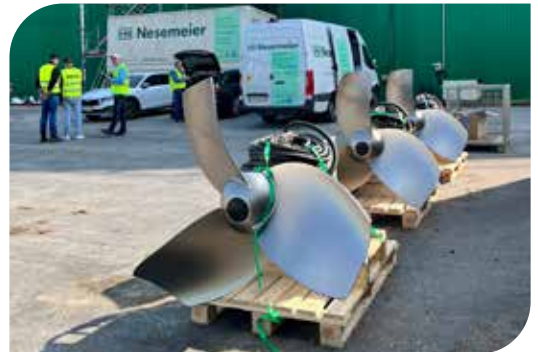
Xylem Flygt 4460 Mixer mit aktivem Dichtungsschutz
