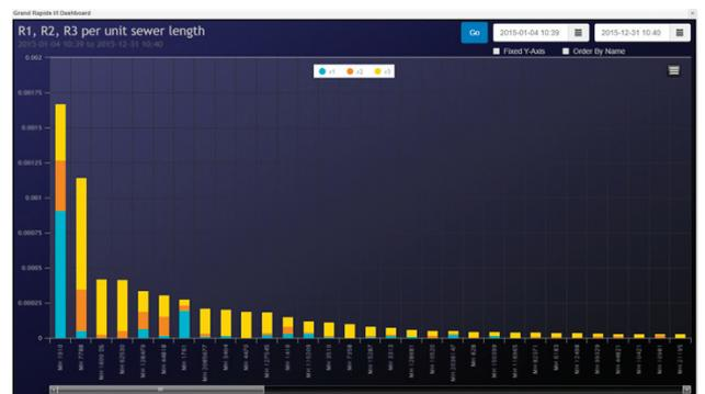
Eine Visualisierung der BLU-X™ Plattform für die Charakterisierung des Fremdwassers für die jeweiligen Kanalsegmente.
