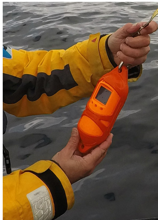
CastAway-CTDは導電率、水温、深度を測定します。
